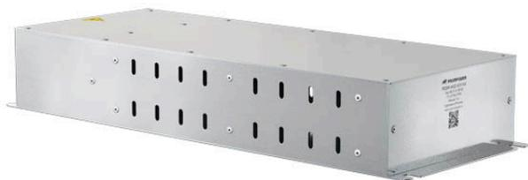
Тормозной резистор PROMPOWER PDBR-55K-12R-2, мощность 55 кВт, 12 Ом, ПВ 2% (120 с), IP 54, способ подключения: клеммная колодка, корпус из оцинкованной стали, габарит М4 (Ширина 140 мм; Высота 70 мм; Длина 460 мм) масса 7 кг.
