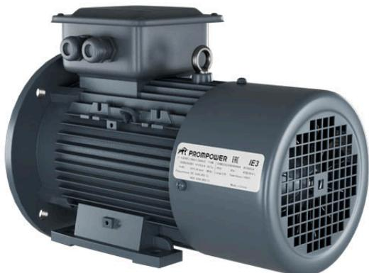
Асинхронный двигатель PROMPOWER 1LE9, номинальная мощность 37 кВт, номинальная частота вращения двигателя 1000 об/мин, габарит 250М, комби IM B35, номинальное напряжение 380/660 В
